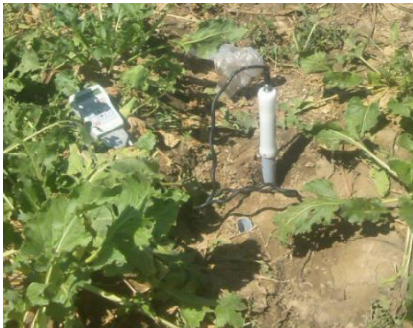
شکل ۳-۱۷- دستگاه تراپم برای اندازه‌گیری رطوبت خاک در مزارع میاندوآب
