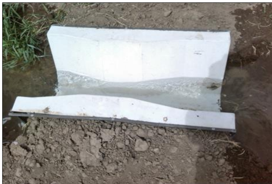
شکل ۳-۱۵- جریان آب از داخل WSC فلوم تیپ ۴ در مزرعه آقای محمدزاده، کانون میاندوآب
