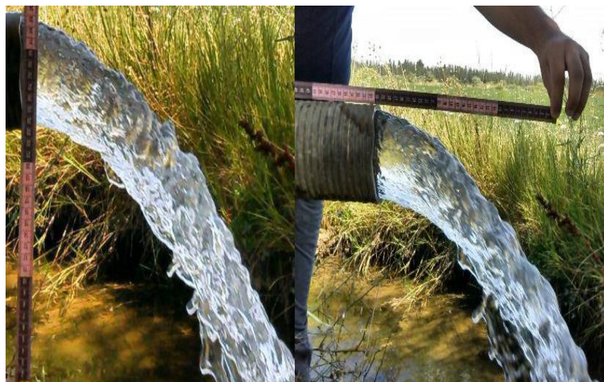
شکل ۳-۲۰- اندازه‌گیری دبی به روش نیمرخ پرتابه‌ای افقی در مزرعه H۱ - کانون میاندوآب
