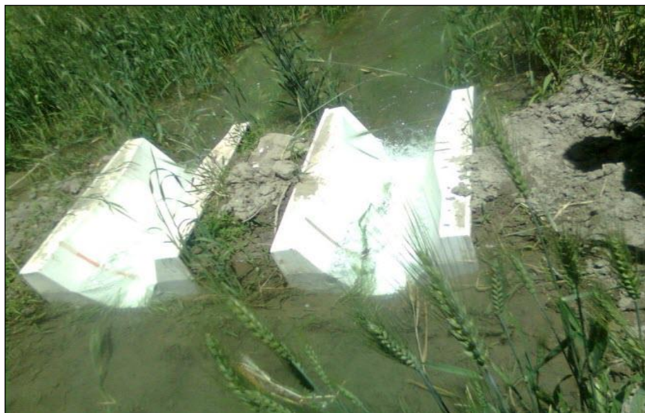
شکل ۳-۱۴- جریان آب از داخل WSC فلوم تیپ ۴، کانون سلماس
